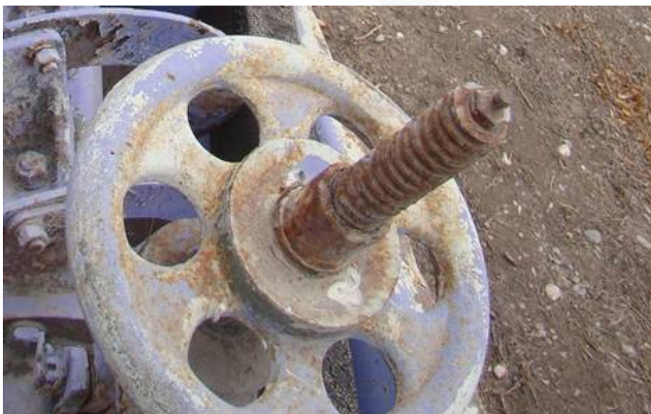
Figura 1. Formación de óxidos de hierro en una estructura formada por una aleación de hierro expuesta a la atmósfera abierta, causando un deterioro irreversible.
