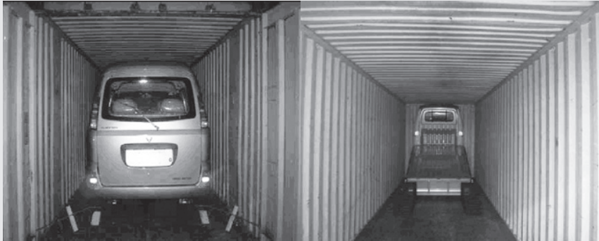
Gráfico A1. Vehículos embalados dentro de un contenedor de 40" ST
