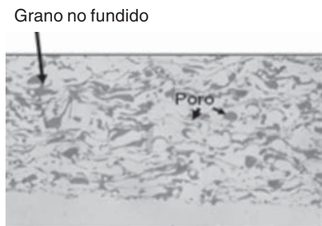
Figura 9. Micrografía recubrimiento de capa base 380 µm, 200X
