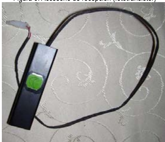
Figura 9. Accesorio de recepción (fototransistor)
