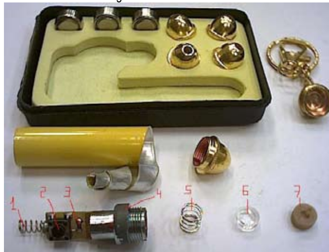
Figura 5. Partes del Láser
