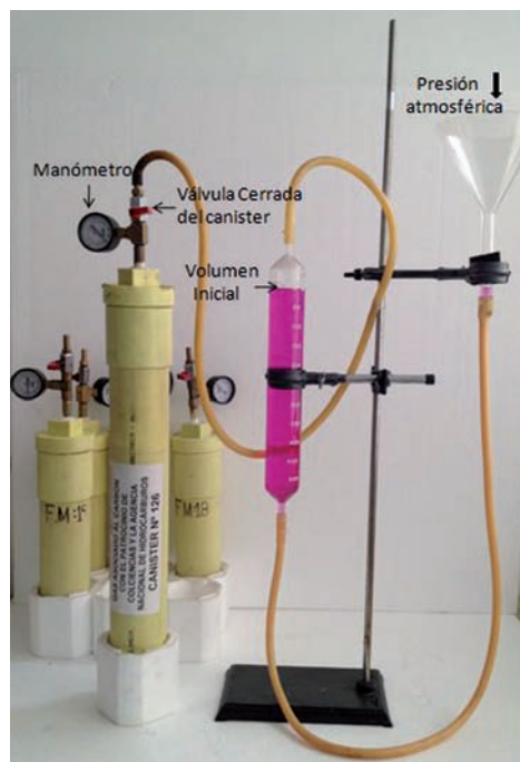
FIGURA 4. Cánister de PVC (cámara hermética), con manómetro y adaptador para termocupla en su tapa, ensamblado con el manómetro tipo bureta y con todos los implementos necesarios para medición del gas desorbido mediante desplazamiento de una columna de agua.
