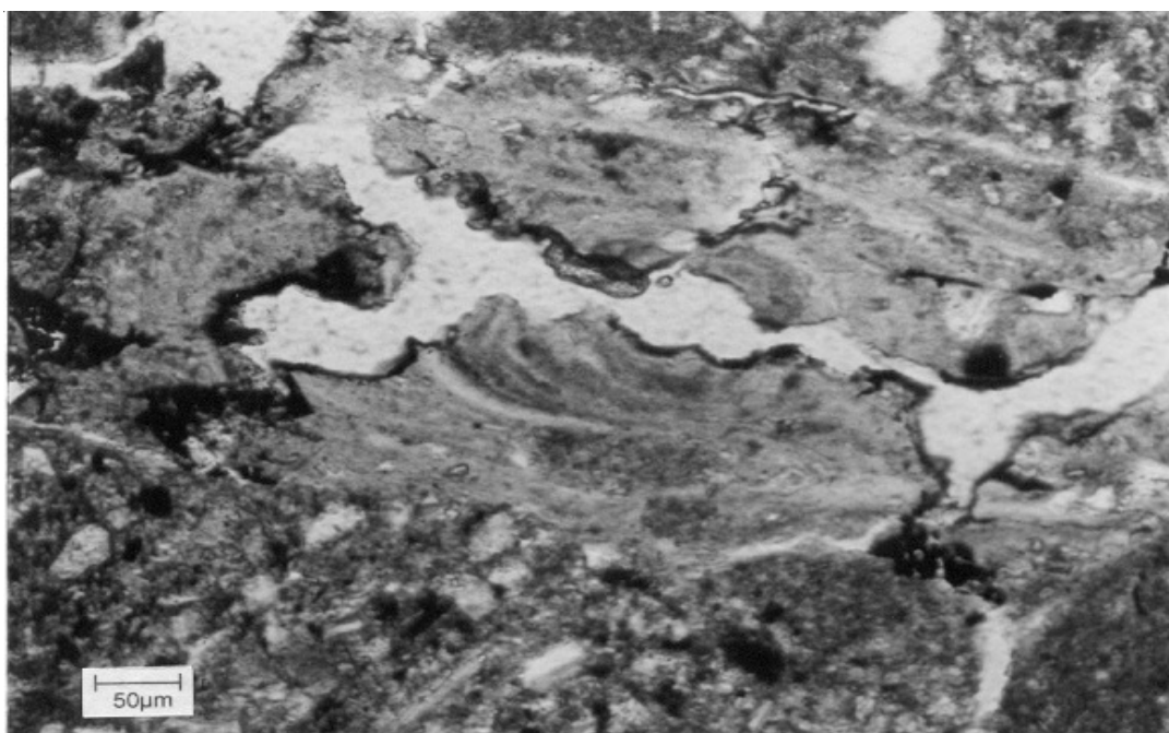
Figura 7: Microfotografía de revestimientos compuestos texturales con superposición desordenada de capas de arcilla impura y limo e impregnación irregular de sesquióxidos. Unidad D, (3Btkgb3, 4,45 - 4,30 m). X 20.
