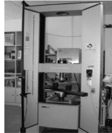
Figura 1. Máquina de tracción mecánica Shimadzu AGX de 100KNewton.
