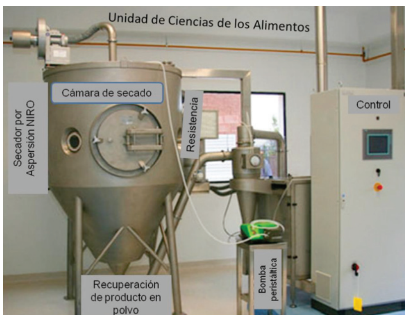
Figura 1. Secador por aspersión Niro usado para obtener sandía en polvo.
