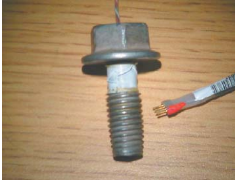
Figura 5. Tornillo autorroscante instrumentado con galgas extensiométricas.
