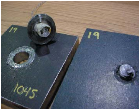
Figura 9. Fractura de tornillo en acero SAE 1045.
