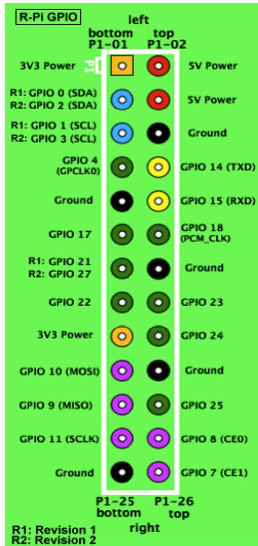
Figura 2. Asignación de pines GPIO en la Raspberry Pi “Modelo B, rev 1” y “Modelo B, rev 2”
