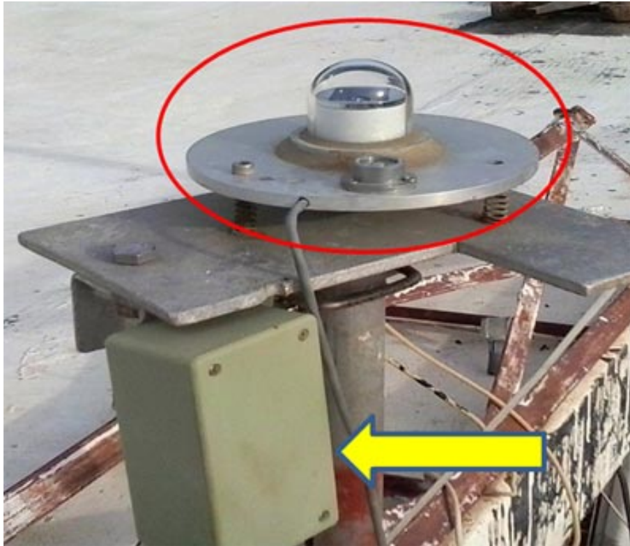
Figura 8. Piranómetro horizontal de irradiación global (señalado con ovalo rojo) integrado a la “Raspberry Pi” (no visible en la figura, instalada dentro de la caja señalada con la flecha amarilla)
