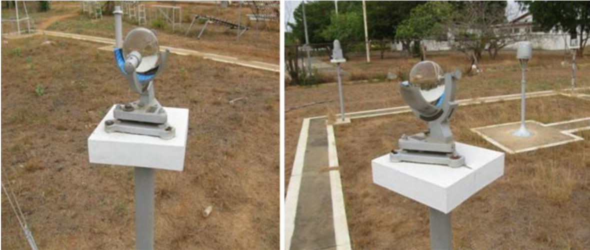
Figura 7. Registrador de horas de brillo solar “Campbell-Stokes” (visible en primer plano), se observa claramente la cinta de registro en color azul
