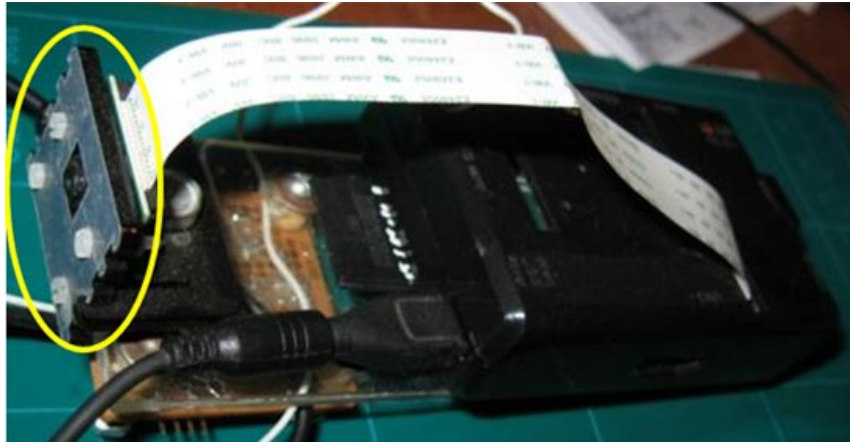
Figura 9. Módulo de cámara HD “PiCam” (señalado con ovalo amarillo) instalado en el minicomputador “Raspberry Pi”
