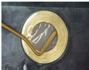
FIGURA 2 – Inserção do material restaurador na matriz metálica.
