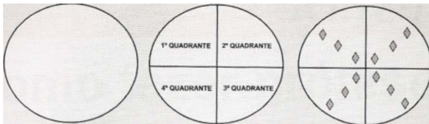
FIGURA 5 – Superfície do corpo-de-prova dividida em quatro quadrantes, com as respectivas indentações (adaptado de Souza et al., 2005).
