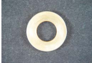
FIGURA 1 – Matriz metálica circular utilizada para confecção dos corpos-de-prova.
