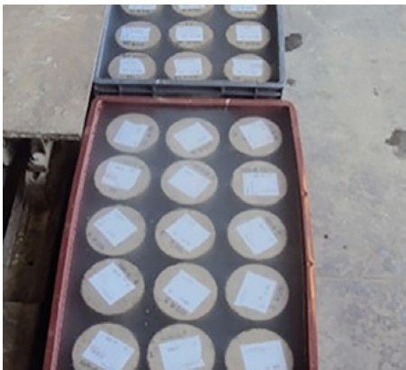
Figura 13. Inmersión de las probetas para el curado.
