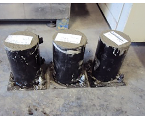
Figura 6. Probetas cilíndricas de 10 x 20 cm (MCV). Fuente: elaboración propia (2019). CC BY
