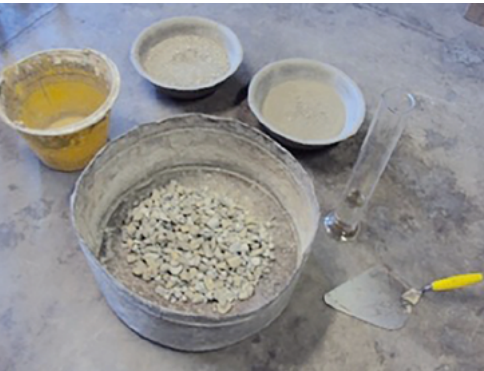
Figura 1. Materiales para las mezclas. Fuente: elaboración propia (2019). CC BY
