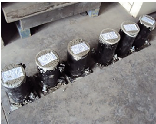
Figura 14. Probetas de MCV y MSM para fallado a siete días.
