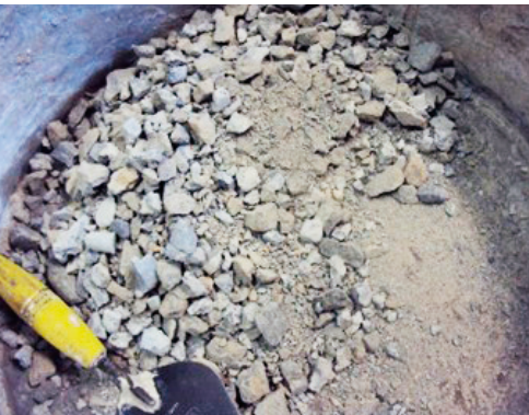
Figura 2. Mezcla de agregados grueso y fino en estado seco. Fuente: elaboración propia (2019). CC BY
