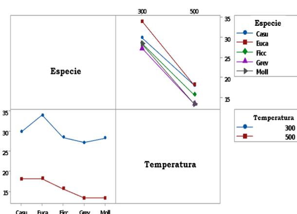
**Figura 2.** Interacción de especie y temperatura en la determinación de carbono oxidable.
