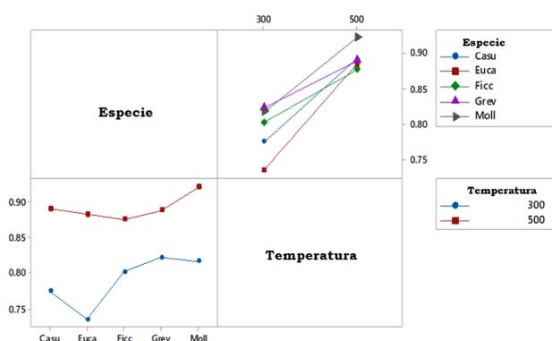
**Figura 4.** Interacción de especie y temperatura en la determinación del grado de estabilidad.
