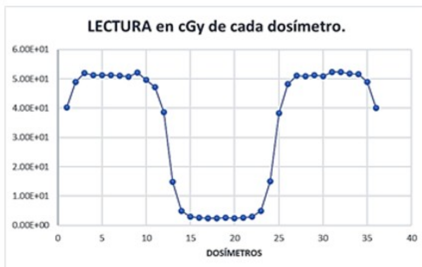
Fig. 5. Gráfica unida de las figuras 2, 3 y 4. Curva de la dosis absorbida y valores de dosis registradas en los dosímetros del maniquí real de Giap. El comportamiento con la curva obtenida por la simulación GATE del maniquí virtual es evidente.
