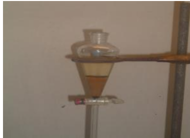
Figura 2. Obtención del biodiesel, separación de las fases
