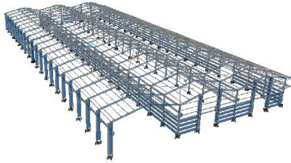
Figura 2. Modelo geométrico del edificio
