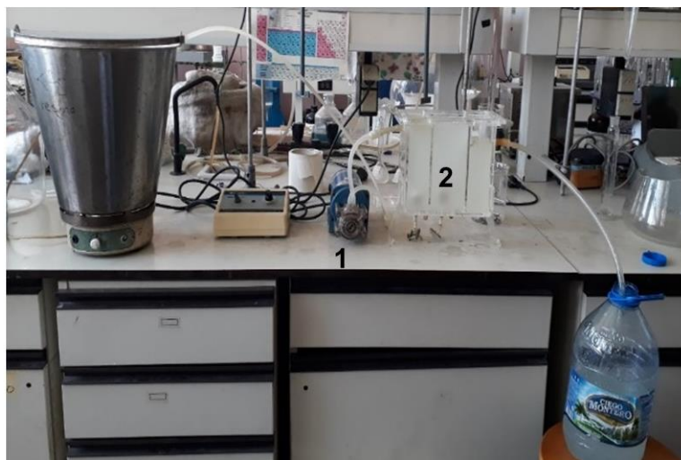
Fig. 2. Bomba peristáltica (1) y Trampa de grasas - sedimentador primario (2).
