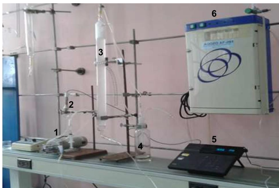
Fig. 3. Sistema de ozonización: Bomba peristáltica (1), electrodo de pH (2), columna de ozonización (3), trampa de espuma (4), pHmetro (5), equipo ozonizador (6).
