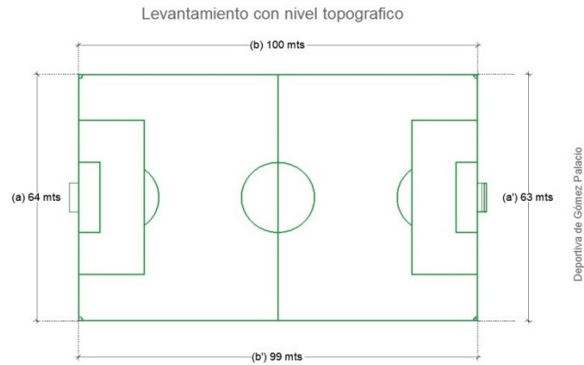
Fig.8 Resultado de levantamiento con nivel topográfico Elaborada por el autor.
