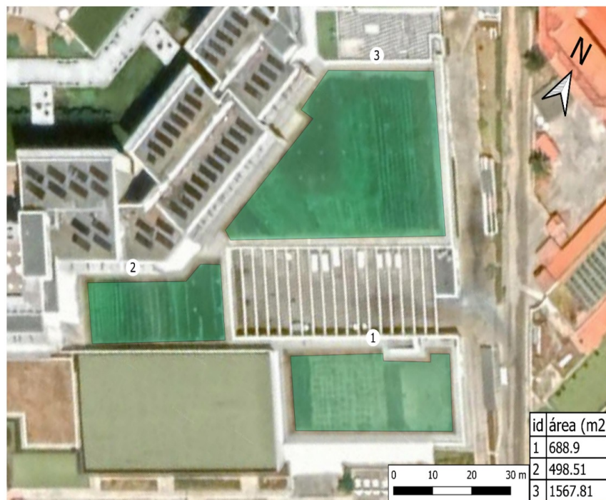
Figura 3 Parcelas de techos verdes en el Hotel Internacional de Varadero Elaboración propia.
