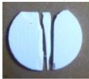
Fig. 7. Característica de fractura de las muestras producto del ensayo de compresión diametral.
