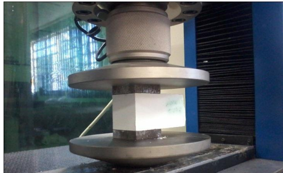
Fig.4. Montaje para la realización del ensayo de compresión
