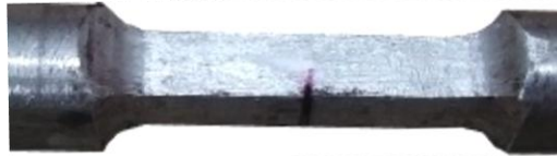
a) ) Medición de la grieta (3,01 mm) en la probeta 4
