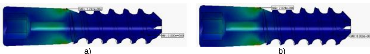
Fig. 6. Gráficos de deformaciones en el implante calcáneo stop . a) 3,741 \times 10^{-4} para el acero inoxidable AISI 316L, b) 7,024 \times 10^{-4} para la aleación titanio Ti-6Al-4V
