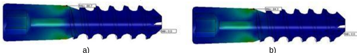
Fig. 5. Gráficos de tensiones equivalentes en el implante calcáneo stop . a) 88,73 MPa para el acero inoxidable AISI 316L, b) 84,29 MPa para la aleación titanio Ti-6Al-4V
