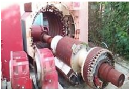
Fig.1. Vista del rotor y el estator inutilizados
