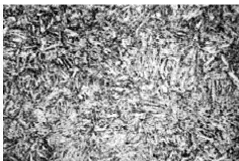
Fig. 3. Metalografía perno no averiado. 200 X
