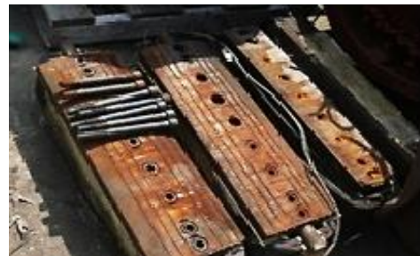
Fig.2. Zapatas polares desprendidas y pernos dañados
