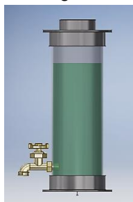
Fig. 5. Contenedor del fotobiorreactor con llave de extracción
