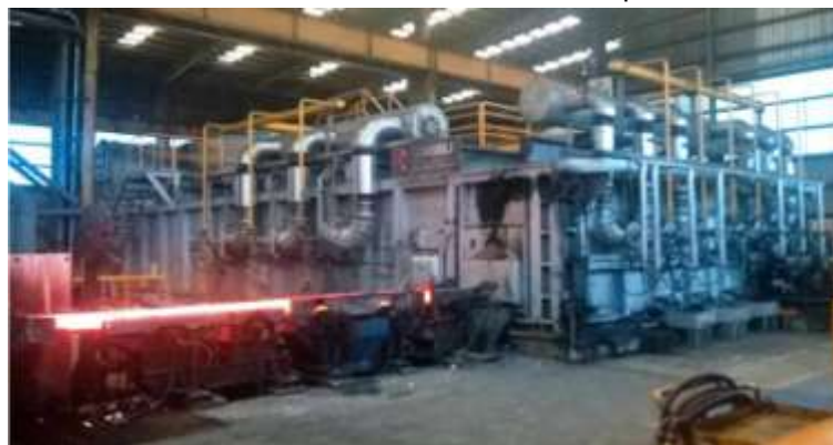
Fig. 1. Horno de calentamiento visto desde la puerta de descarga
