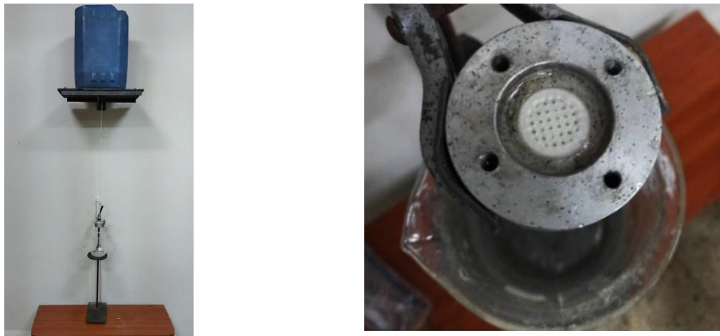
Fig. 3. Instalación experimental para determinar la permeabilidad de andamios porosos. Fuente: autores
