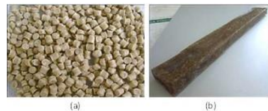
Figura 2. Muestra de pellets conformados en la mezcladora en seco y (b) Probeta de WPC obtenida por extrusión.
