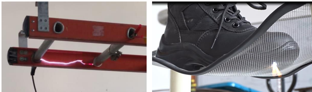
Figura 11. Ensayo a escalera y calzado dieléctrico
