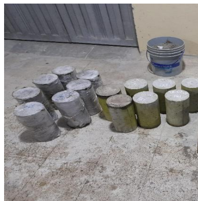
Figura 2. Cilindros curados a la intemperie sin cobertura y con papel film
