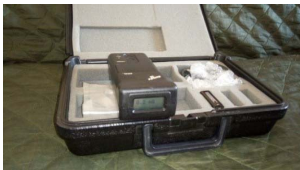
Fig.1. Gaussímetro EMDEX II, utilizado para realizar las mediciones.
