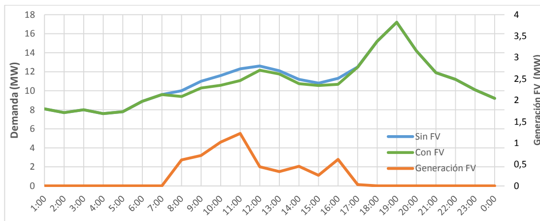
Fig. 4. CCCD típica en invierno con un PSFV de 1 MWp conectado a la red.
