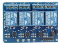
Tarjeta módulo de relé con cuatro canales con optoacoplador
