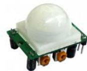
Sensor infrarrojo de movimiento PIR HC-SR501
