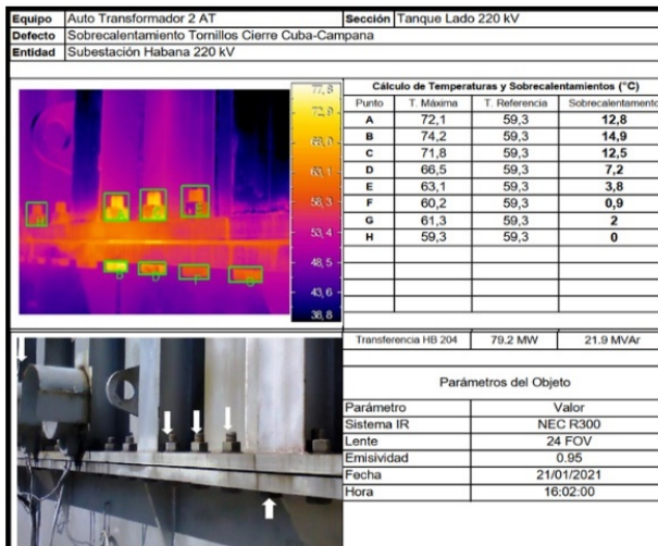
Imagen 1. Calentamiento de la tornillería por el lado de 220 kV, frente a la fase C
