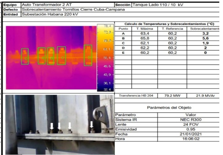
Imagen 3. Calentamiento de la tornillería por el lado de 110 kV, frente a la fase C
