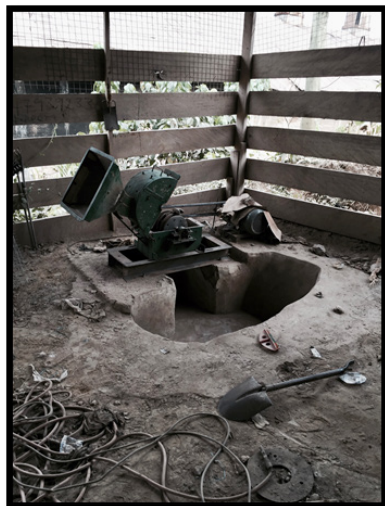
Imagem 2 - Máquina de fragmentação de rochas (crusher) em estabelecimento de pequena mineração em Tarkwa (Western Region). Gana, 2016.
