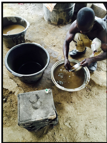
Imagem 5 - Minerador misturando ouro e mercúrio em Tarkwa (Western Region). Gana, 2016.
