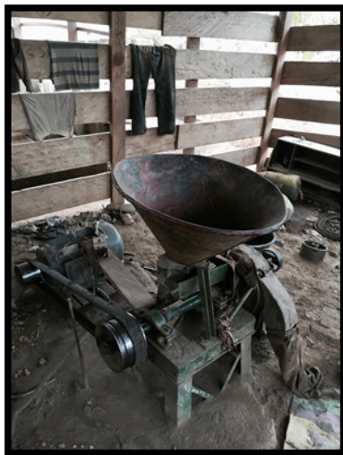
Imagem 3 - Máquina de fragmentação de rochas (smother) em estabelecimento de pequena mineração em Tarkwa (Western Region). Gana, 2016
