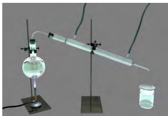
Figura 2. Esquema básico usado na destilação de um sistema.
