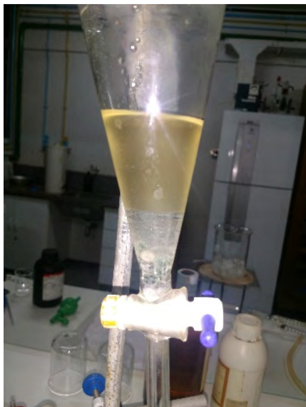
Figura 5. Foto em que se pode identificar as fases superior e inferior quando o conteúdo reacional do balão é tratado com salmora ao final da reação.
