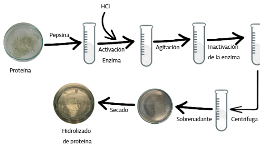
Figura 4. Esquema del Hidrolizado de proteína.
