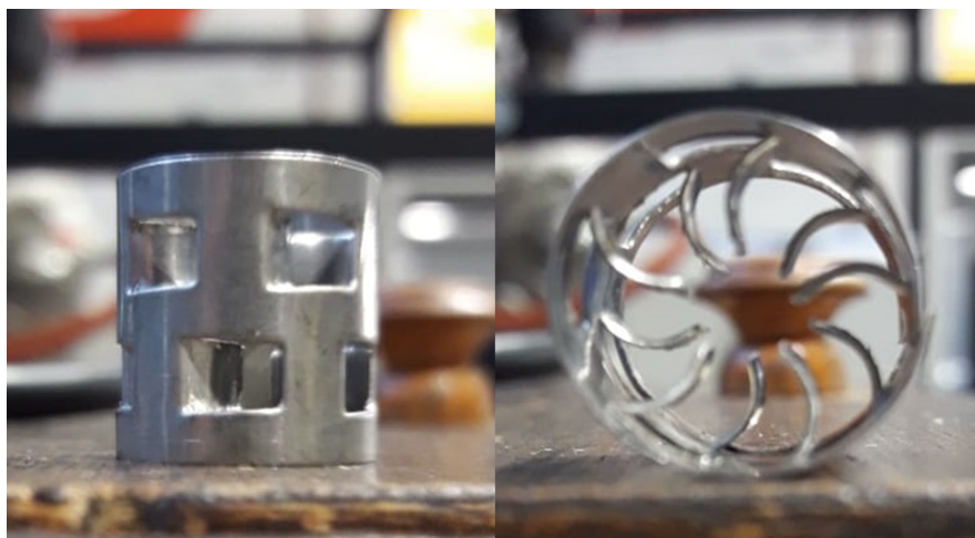
FIG. 3. Anillos tipo pall de la torre empacada marca Didacontrol Fuente: elaboración propia.
