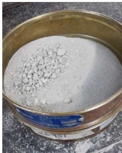
FIGURA 4. Proceso de tamizaje de los cerámicos provenientes de los RCD
