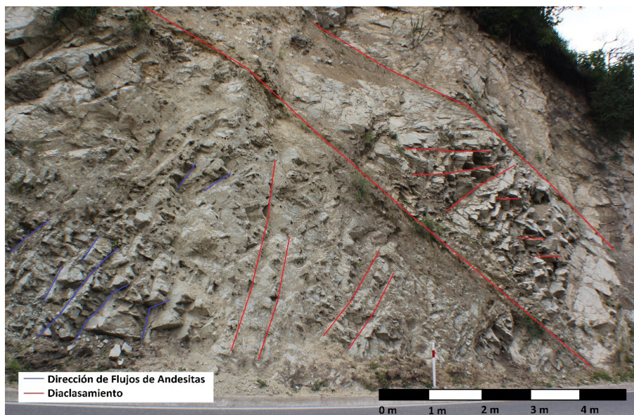
FIGURA 3. Afloramiento de rocas intrusivas tonalíticas (G t). En esta imagen, el afloramiento muestra un rumbo E-W, lo cual permite observar en primer plano, diaclasas estructuradas en sentido NNE-SSW, buzamiento 40^{\circ} W. Adicional, es posible la observación de otras familias de diaclasas que se agrupan de manera casi paralela; entre las cuales sobresalen los sistemas que siguen la dirección de flujo (NNW – SSE), y otras diaclasas casi perpendiculares a la dirección de flujo (E – W)
