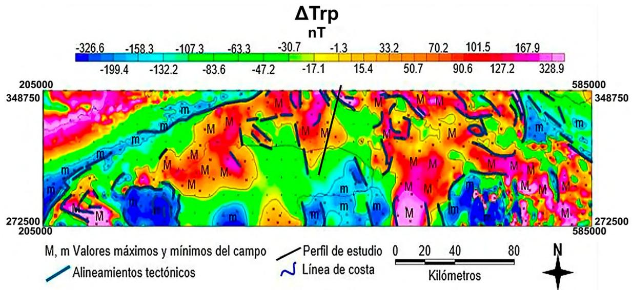
Figura 4. Cartografía geólogo-estructural por datos magnéticos ( $\Delta T_{250rp}$ ).
