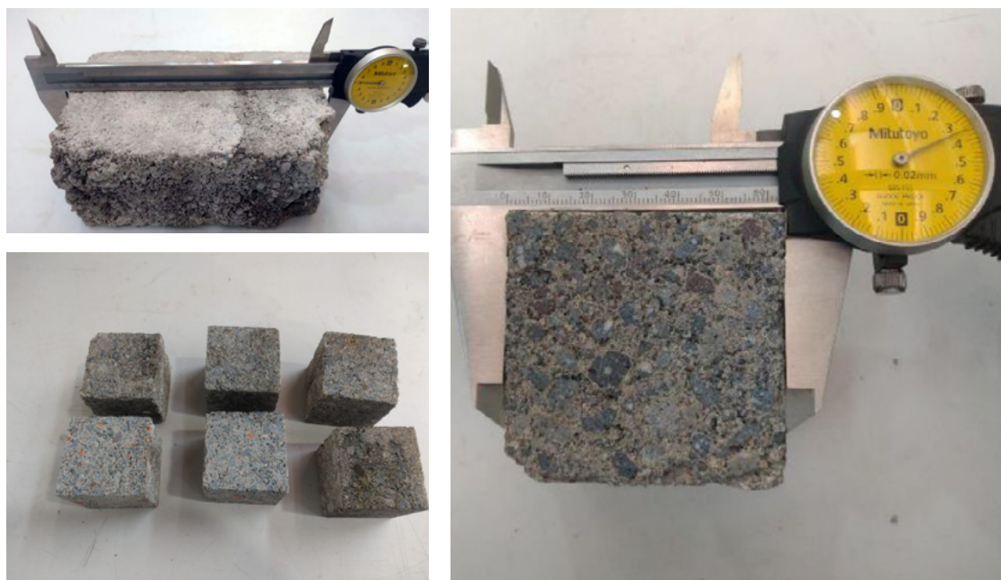
FIGURA 4. Tres imágenes que muestran el proceso de preparación de la pieza en 2020. Para adquirir la resistencia a la compresión, se aplicó una carga a una velocidad constante y paralela a la dirección longitudinal de la probeta, registrando la carga máxima a la falla ( F_{ult} ), similar a lo realizado por otros investigadores (Fotografías: Alejandro Leal y Alberto Muciño, 2021; fuente: colección de los autores).
