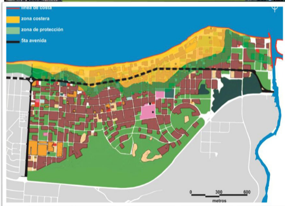
Figura 2. La franja amarilla indica el alcance actual de las inundaciones ligeras que debería establecerse como zona costera y la franja verde correspondiente a las inundaciones moderadas la que debe definir la zona de protección. Fuente: Asbel Aldana. Tesis de diploma. Facultad de Arquitectura. 2012-2013. Tutores: MSc. Jorge L. Rodríguez Viera y Dr. Obdulio Coca.
