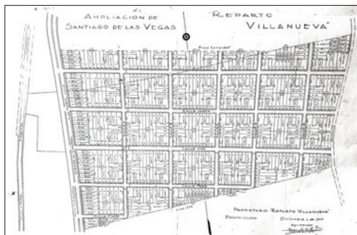
Figura 14. Trazado ortogonal con manzanas y parcelas del reparto Villanueva (1949). Fuente: Contrato de Compra-Venta del Reparto Villanueva, otorgado en 1950, Archivo del Museo Municipal de Boyeros.
