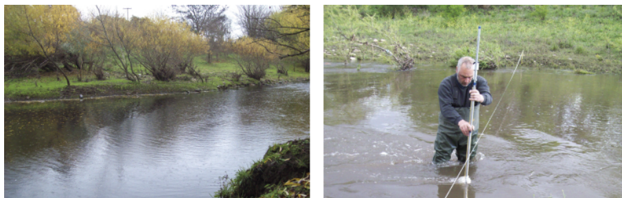
FIGURA 3. A) Y B) a) Sección de aforo correspondiente a la Estación Limnigráfica L1. b) Tareas de aforo con equipo de correntómetro electrónico digital con integración de velocidad media y máxima. Fuente: Fotografías tomadas por Pablo Ábalo.
