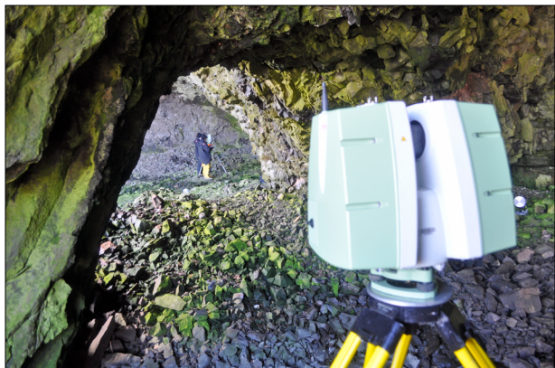
Figura 5. Laser scan Leica P20 no interior da Caverna Lima Lima. Fonte: LEACH (2018).
