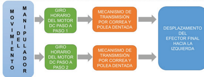
Figura 14. Diagrama de bloque del desplazamiento del efector final hacia la izquierda
