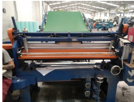
Figura 3. Rodillo instalado en la máquina de división de rollos de EVA
