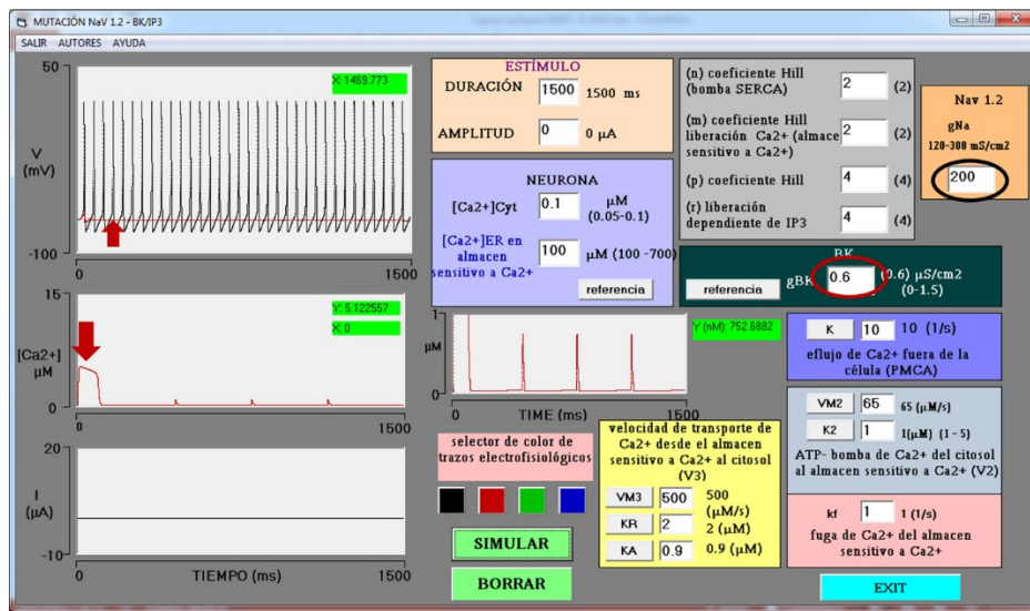
Figura 3. Efecto del complejo BK/IP 3 -R en la epilepsia simulada por mutación del canal de sodio. En el osciloscopio central se observa la salida de Ca^{2+} del retículo y sus oscilaciones. La amplitud de la salida abrupta de Ca^{2+} alcanza 5.12 \text{ mM} (flecha roja inferior). La conductancia de sodio permanece en 200 \text{ mS/cm}^2 (círculo negro). La conductancia g_{BK} es de 0.6 \text{ } \mu\text{S/cm}^2 (círculo rojo). La activación de los canales BK por Ca^{2+} bloquea completamente la actividad eléctrica epiléptica de la neurona (trazo en rojo, señalado con flecha roja, en el osciloscopio superior).
