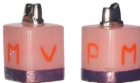
Figura 1. Modelos maestros en Co-Cr conterminación en bisel y en chamfer.
